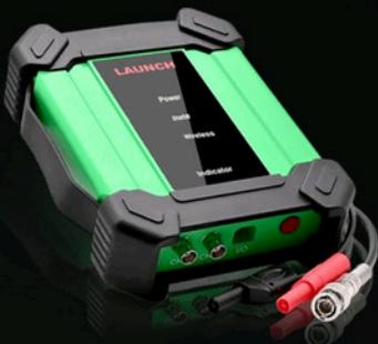
Le LAUNCH EM101 est un outil double et innovant qui combine les fonctionnalités d'un oscilloscope et d'un multimètre en une seule unité. Idéal pour mesurer le courant, la tension et la résistance dans les véhicules équipés de batteries haute tension, il offre des options de communication filaire et sans fil en conjonction avec le X-431 EURO TAB 3. Sa facilité d'utilisation fait de l'EM101 le premier choix pour les ateliers de réparation automobile et leurs professionnels.
