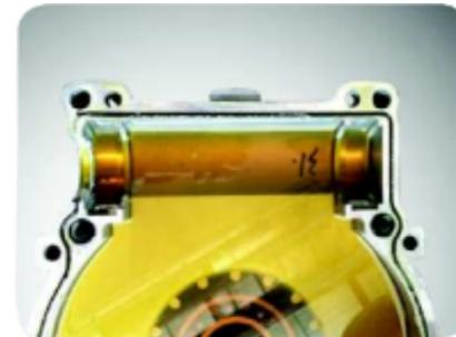
Le mécanisme de rotation utilise une huile spéciale pour réduire les frottement et éviter la maintenance de graissage.
